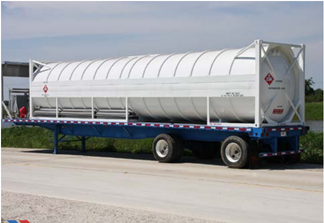
40 ft LNG ISO container
